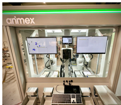
Med två robotar, fyra matarenheter och många olika gripdon kommer robotcellen att montera 13 olika artiklar.
