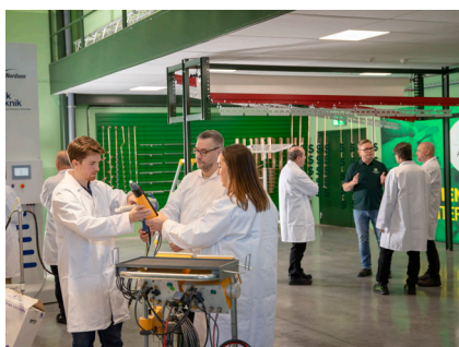
Praktisk genomgång med val av munstycke till pistol – en viktig fråga när man ska applicera pulver.
